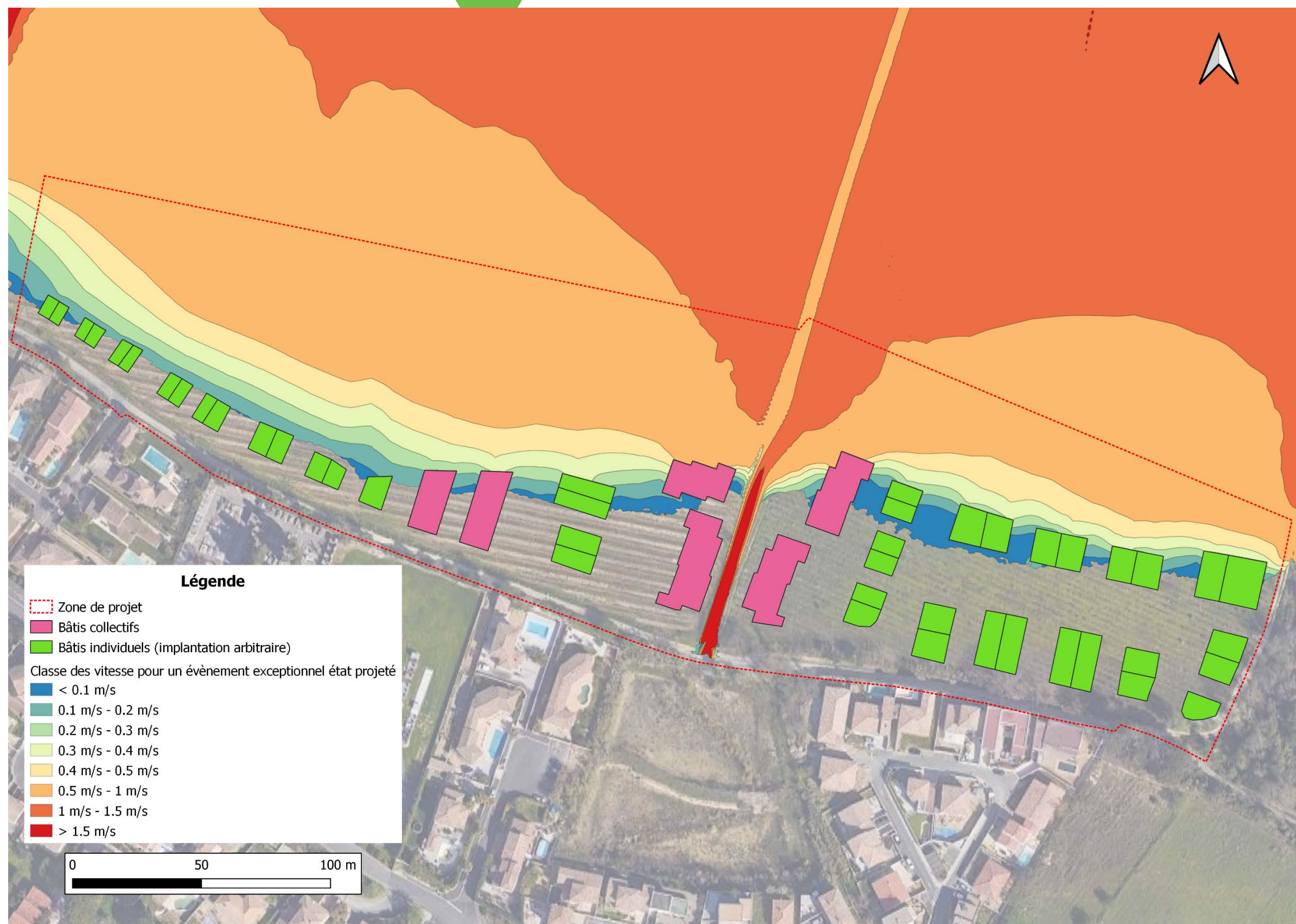
Figure 42 : Vitesses pour l'occurrence exceptionnelle en état projeté
