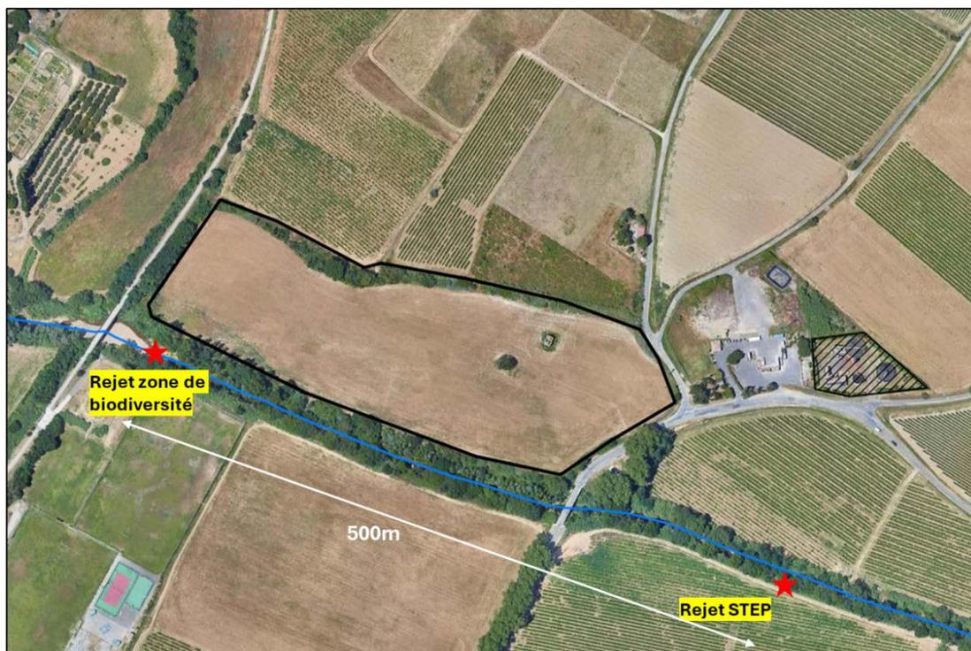
L'apport en eau dans la zone de biodiversité sera continu, en fonction du débit de sortie de la station d'épuration. Un débit maximal de 40 m<sup>3</sup>/h sera envoyé vers la zone de biodiversité. Au-delà, une partie de l'eau sera rejetée directement dans le Libron par la canalisation actuelle de rejet de la STEP. De plus, selon le SAGE ORB-LIBRON, la qualité chimique et microbiologique du Libron est mauvaise après la commune de Boujan-sur-Libron.
