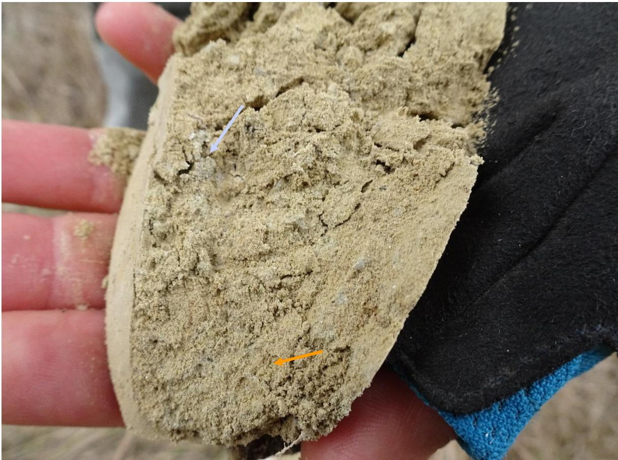
**Traces d'hydromorphie (taches orangées d'oxydation, flèche orange ; et grisâtres de déferrification flèche grise) du sondage n°9 – CBE, 21 octobre 2021**
