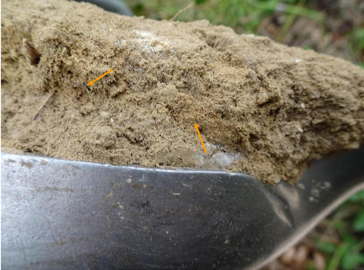
**Traces d'hydromorphie (taches orangées d'oxydation, flèches orange) entre 0 et 25 cm du sondage n°7 – CBE, 21 octobre 2021**
