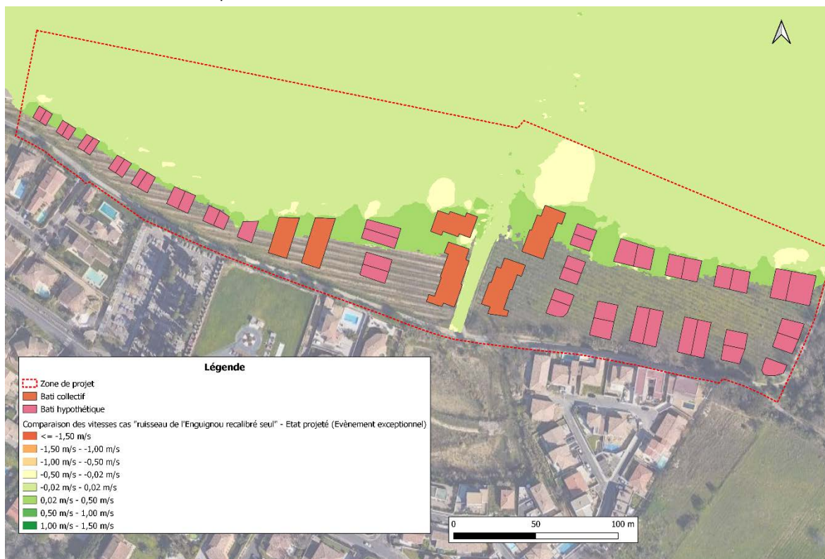
Figure 47 : Différence de vitesse Etat initial avec recalibrage Enguignou moins Etat projeté pour l'occurrence exceptionnelle
