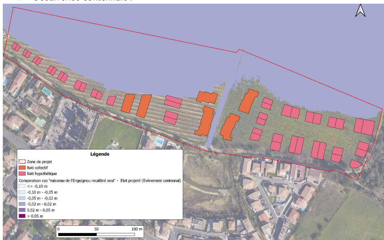
Figure 42 : [Cotes PHE Etat initial avec recalibrage Enguignou] moins [cotes PHE de l'Etat projeté pour l'occurrence centennale]
