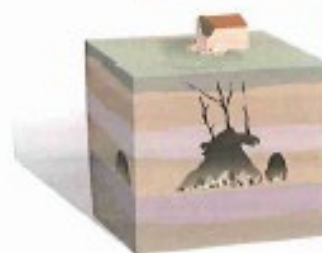
Effondrement de la cavité
